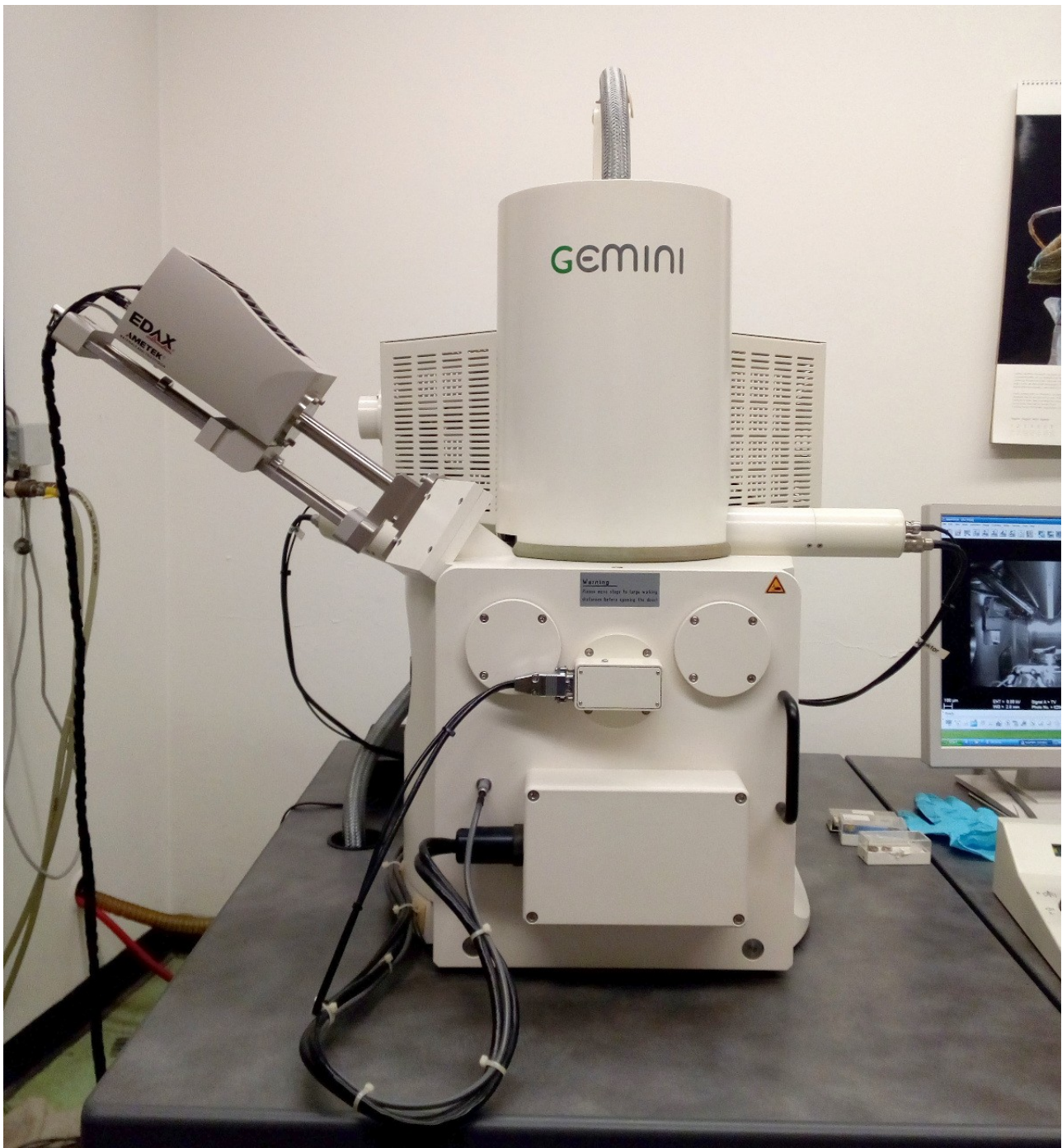
Foto 4: REM der Uni Hamburg mit EDAX-Scanner Der EDAX-Scanner erlaubt die Analyse der Probenzusammensetzung
