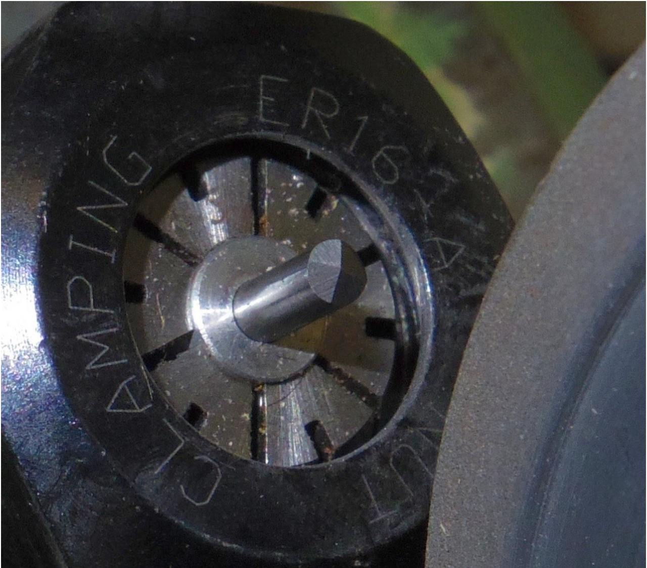
Foto 2: Schleifen einer Vickers-Prüfspitze aus Wolframcarbid. Durchmesser 3mm Die Abmessungen des Eindrucks im Werkstück erlauben eine Bestimmung der Härte.
